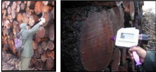
Figure 6 : Le SPIR est composé d'un pistolet et d'un boîtier pour l'alimentation et le stockage des données
