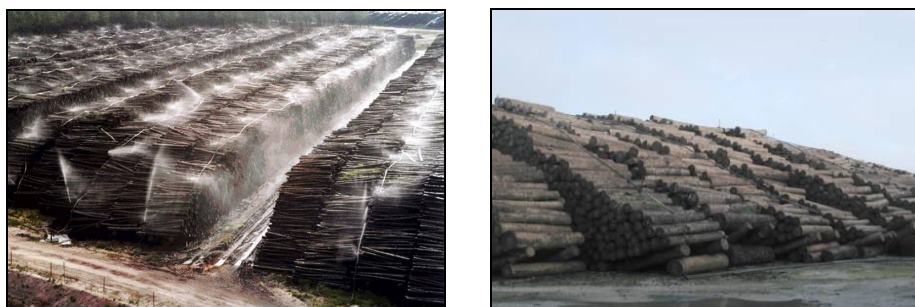
Figure 4 : Plates-formes de stockage de bois de pin maritime sous aspersion en Aquitaine
